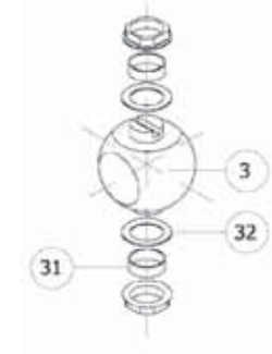
Конструкция крана с шаром на опоре (DN 150–200 PN 4,0 МПа, DN 250–400)
